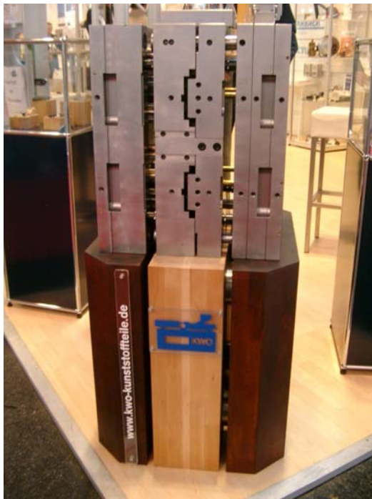
Abb. 1: Fakuma 2006 – KWO präsentiert Stammformwerkzeug mit Schnellwechselsystem auf Messestand
